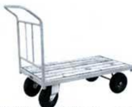
ART. 2099. Skjutvagn 1250 L. Låg vagn utrustad med 2 st fasta hjul och 2 st svängbara länkhjul för stor smidighet. Lastar 550 kg. Kan även erhållas med massiva gummihjul. Tillbehör: Extra gavel och/eller stolpar.
