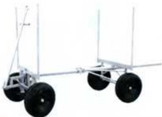
ART. 2096. Långgodsvagn. En mycket populär vagn för långt gods. Stålbart axelavstånd mellan 1750-2950 mm. Lastför måga 2200 kg. Finns även med större hjul och lastförmåga 3000 kg. Kan erhållas med flak.
