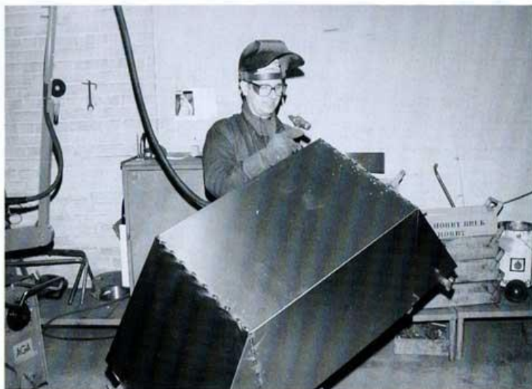
Gert Andersson svetsar fodervagn. Den roterbara fixturen gör att han ensam klarar arbetet och har en bekväm arbetsställning vid svetsningen. Lägg också märke till upphängningen av slangpaketet.
