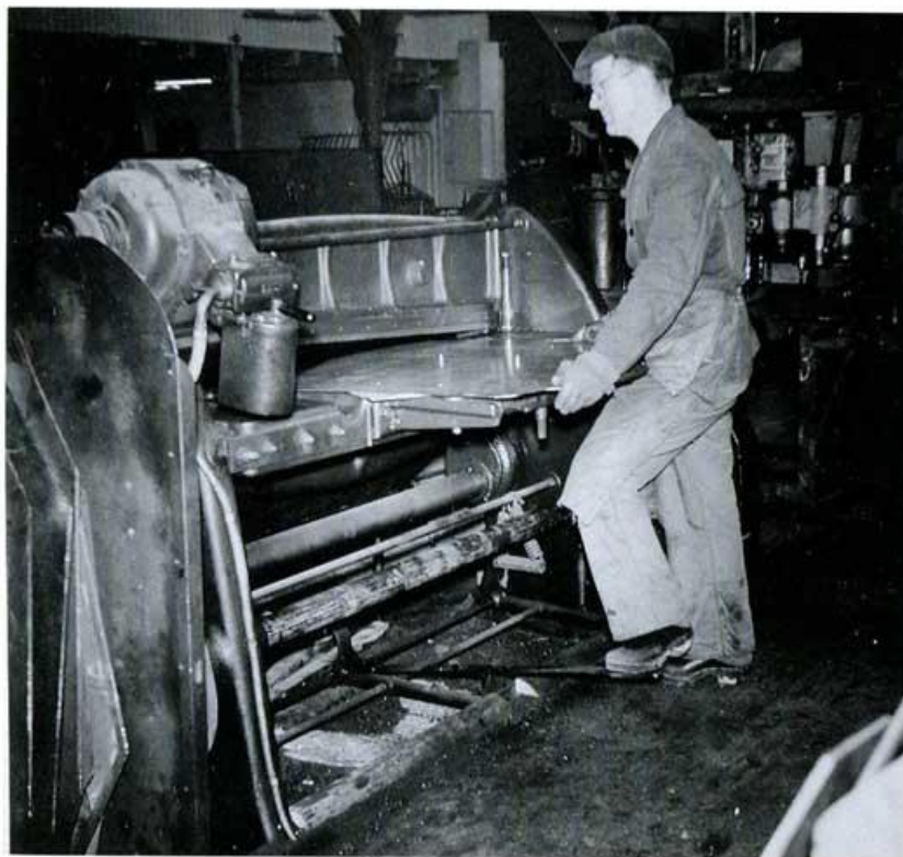
Gunnar Nilsson kantklipper plåt till skottkärrekorgar i Norrtäljegradsaxen
