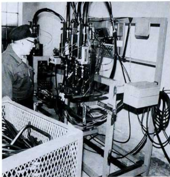
Nils Ove vid en egentillverkad bormaskin för rör bestående av Suhner borrenheter med pneumatisk matning och automatisk borrykel.
