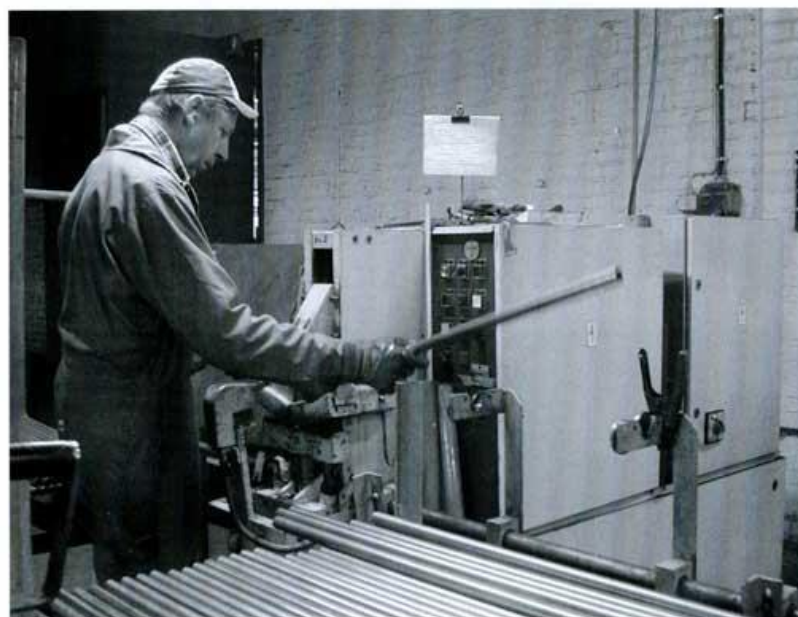
Bernhard Månsson bockar rör i pressbockmaskinen, som är snabb om röret bara har en bock.
