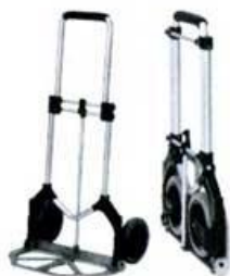
ART. 2047. Handy Lett. Lätt bagagekärra av aluminium. Fälls upp och ihop med endast ett handgrepp. Stora punkteringsfria hjul för bra framkomlighet. Lastar 100 kg.
