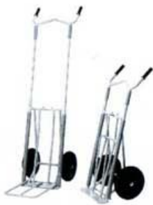
ART. 2055. Höggodskärra. En ryggertä kärra för både högt och lågt gods genom att höjden på handtaget är reglerbart. Stora hjul för bra framkomlighet. Lastar 150 kg.
