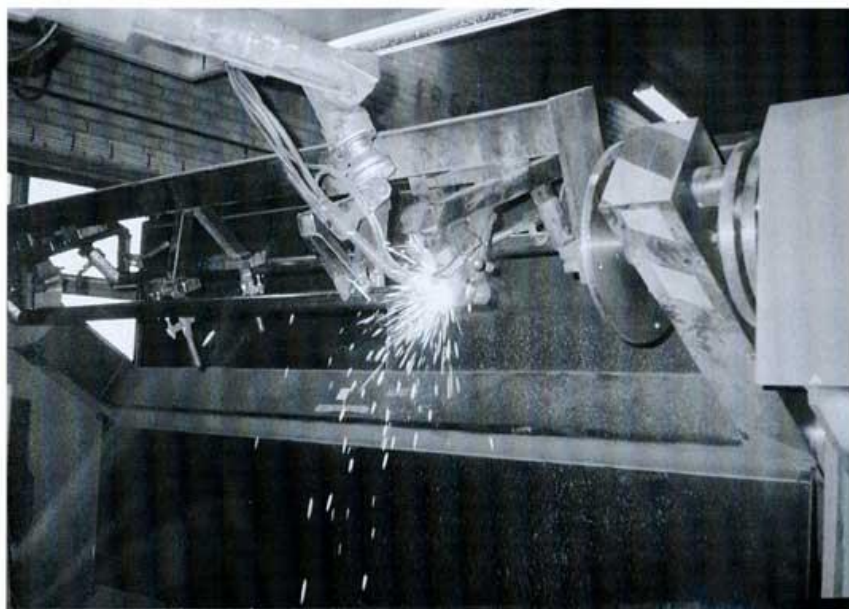
Robotsvetsning av barngungor.
