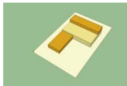
Både tillbyggnad och påbyggnad
