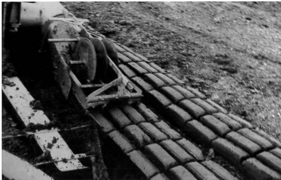
Åkermans kedjefräs, 1958. Detalj av utläggning och delning av torven. Foto i privat ägo.
