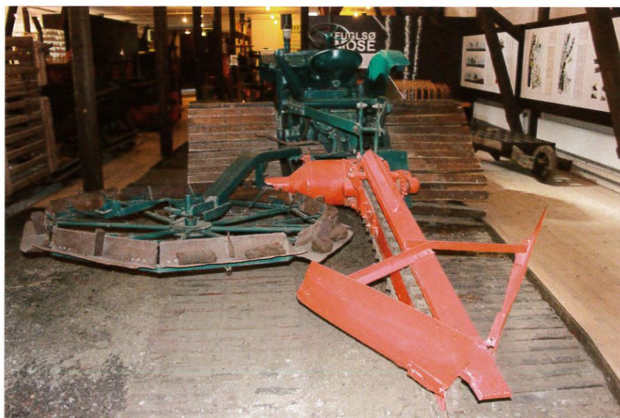
Kedjefräsmaskin system Möckeln. Bilden på "den svenska maskinen" är tagen på torvmuseet i Stenvad på Jylland 2014. Foto: Elisabet Johansson
