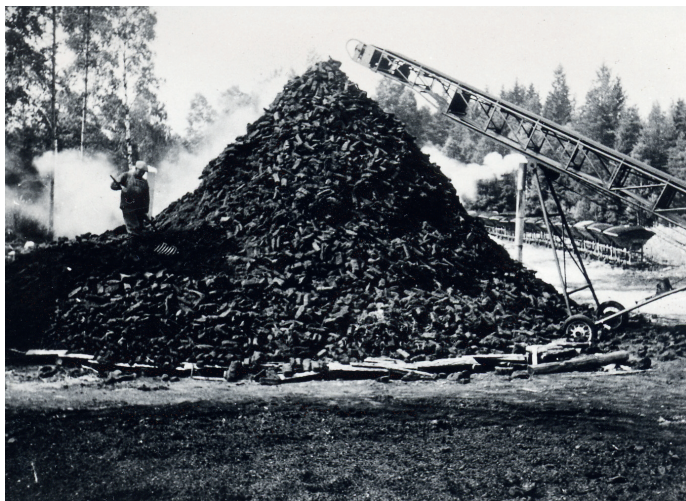
Milan byggs upp av torra torvblock som transporteras fram med traktor och elevator.
