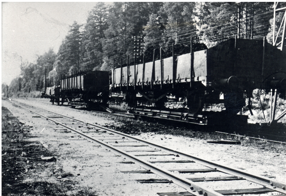
Torvkolet lastades vid Förarps hållplats i överföringsvagnar som kunde växlas över från den smalspåriga järnvägen till normalspår.
